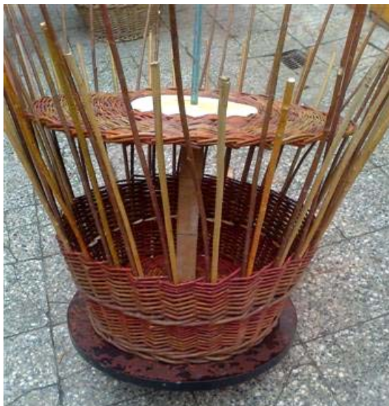
Obr. č. 5 Pomocný kruh je nasadený na oske, kde sú vymedzovacie hranoly držiace ho v požadovanej výške. Oska je vedená cez stred dna a zachytená do stojana. Aby ste nemuseli prídavné stojáky vsúvať veľkou silou, zarežte si ich a už po druhom prepletaní (po prvom ubíjaní) ich pohodlne vsuniete tenšími koncami vedľa stojákov až po dno.
