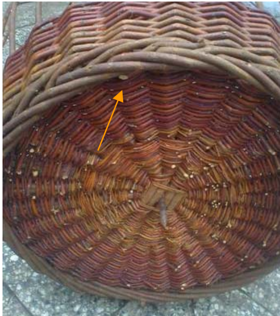
Obr. č. 4 Osnovné prúty pred zdvíhaním do „klietky“ v mieste ohybu napichnete šidlom, výpletové prúty nasúvajte dvoma rukami čo najhlbšie (ak nejdú použite šidlo, ktoré si občas pomastíte), spodná noha vedená cez dno – po tetive, nie po obvode vytvára mohutnú obrubu, chrániacu dno.
