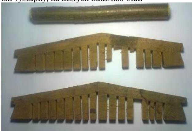
Obr. 44 „Polotovary“ Z latiek dubového dreva som nahrubo vyrezal tvar kríža, pre lepšie dosiahnutie tvaru som urobil viacero zárezov, hore je asi 25 cm kúsok lieskovej palice.
