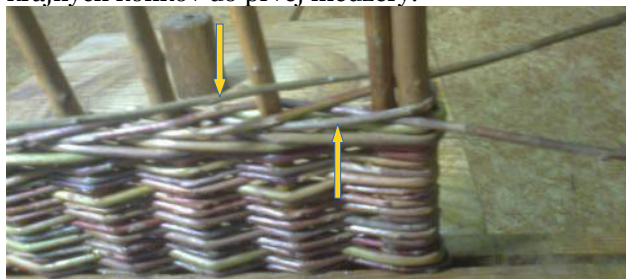
Obr. 21 Prút z druhej medzery po otočení okolo krajných kolíkov smeruje doľava.
