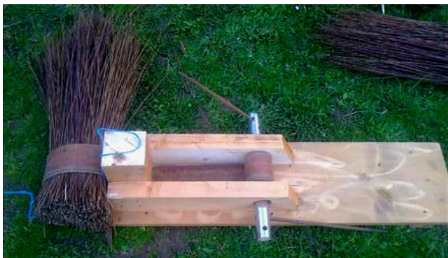
Obr. 42 Točením hriadele pomocou železných tyčiek, ktoré sa nasúvajú do otvorov, sa remeň sťahuje. Na zaistenie proti povoleniu stačí nechať tyčku opretú o zem. Otvory v hriadeli sú vrtané s 90° posunom a 45° posunom medzi pravou a ľavou stranou.
