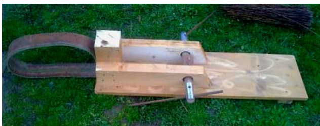
Obr. 41 Na doske sú pripevnené dva prevrtané hranoly, medzi ktorými je vpredu pripevnený ďalší hranol. Na tomto je prichytený remeň, ktorý prechádza k hriadeli. Všimnite si prosím uhol jednotlivých tyčiek zasunutých v hriadeli. Je asi 45°.
