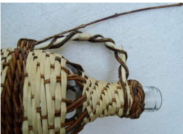
Obr. 12 Pred každým otočením omotkového prúta, musí byť dostatočne nahúžvený ( pozdĺžne pukliny musia byť spojené).
