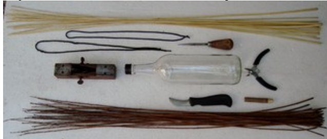
Obr. 1 Nôž, šidlo a klieštiky patria k základnej výbave. Dve šnúrky, vymedzovací kolík pre zhotovenie medzery na ucho a úžidlo na úpravu šírky lubkov.
