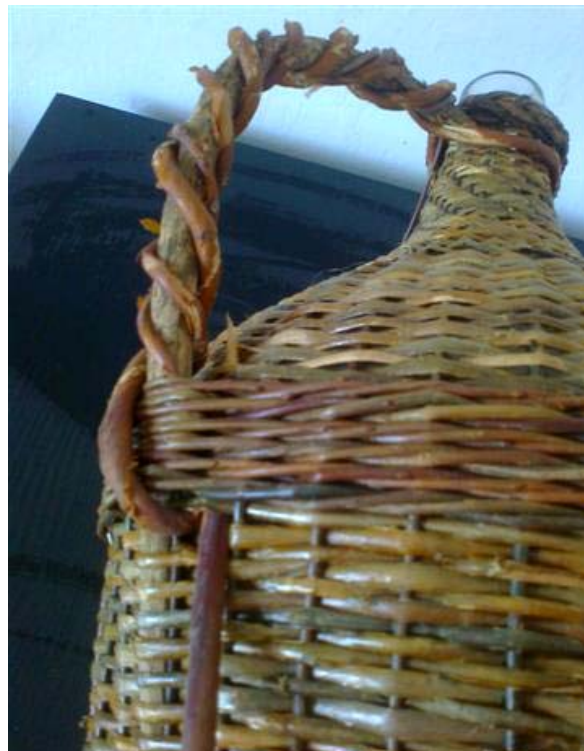
Obr. 13 Zastoknutý omotkový prút popod opasok a výplet zalomte a kvalitne zhúžvite, pred omotávaním kostry prút otáčaním napnite tak, aby sa pozdĺžne puklinky spojili. Pod hrdlom je koniec kostrového prúta, ktorý bol zrezaný na lubok pritlačený ku kostre a už omotaný húžvou.
