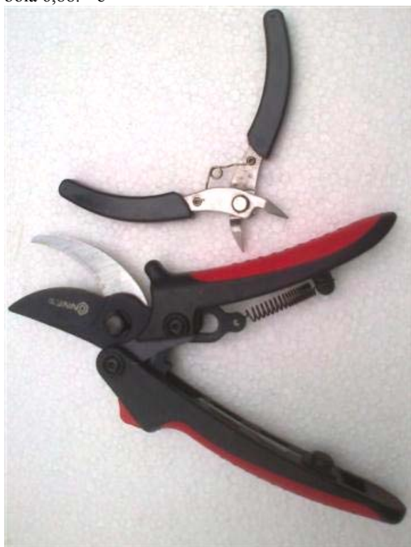
Obr.14 Rúčky sú na kliešťach NAREX pevne pritavené a nezvliekajú sa, dolu nožnice s mierne natiahnutou pružinou
